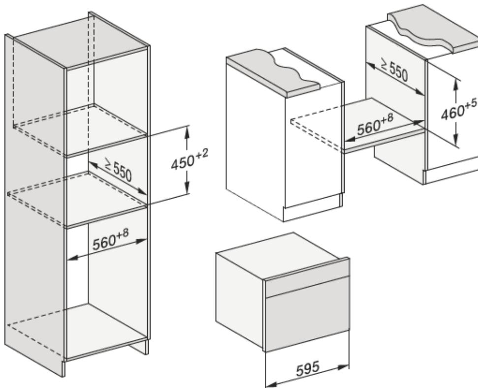
Si tiene previsto montar el horno debajo de una placa de cocción, observe las indicaciones de montaje de la placa de cocción, así como la altura de empotramiento de la misma.
