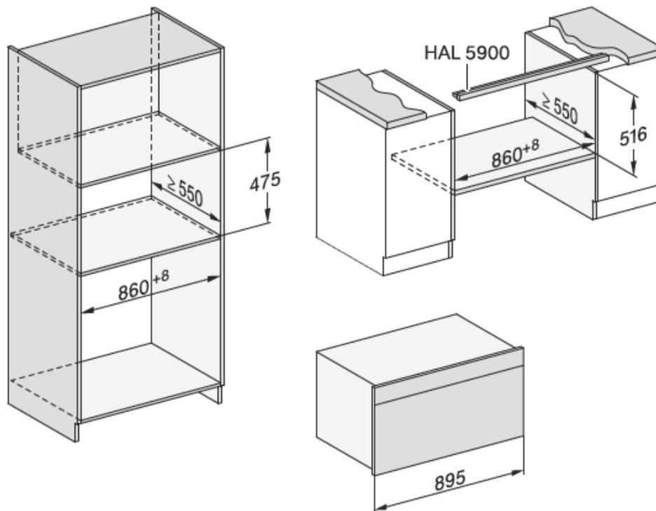
Si tiene previsto montar el horno debajo de una placa de cocción, observe las indicaciones de montaje de la placa de cocción, así como la altura de empotramiento de la misma.
